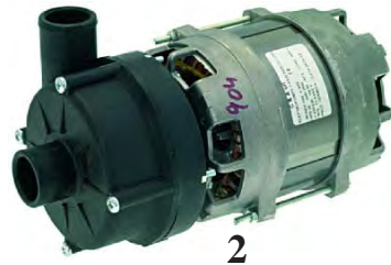
Huuhtelup.1010B 230V 90L/min. 0,2Hp - 0,2 kW - 1,5A - 6,3 uf Sisään 28 mm ulos 28 mm HOBART
